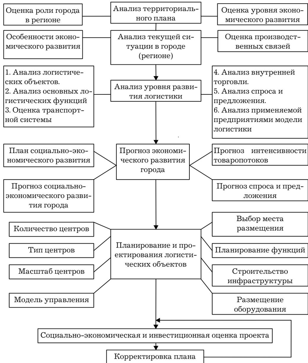
Рис. 4. Блок-схема основных этапов проектирования логистического центра
